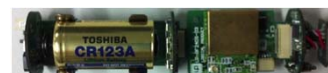
図1: 新規開発のジャイロ・加速度・地磁気センサ搭載動物装着型データロガー
