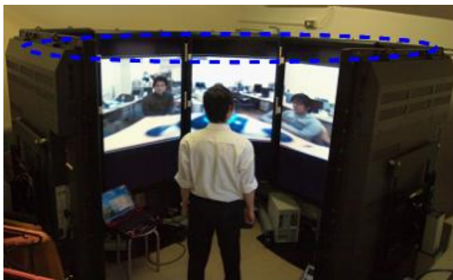
没入型ディスプレイ (左) と身体動作によるロボット操作 (右)
