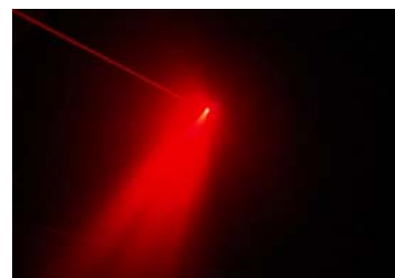
チンダル現象下で物体に赤色レーザを照射した様子を撮影した画像
